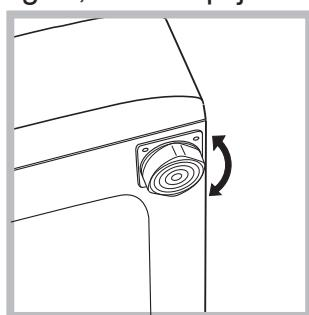
2. Dacă podul sau nu este perfect orizontal, compensați neegalitățile deșurubând sau înșurubând piciorușele anterioare (a se vedea figura); unghiul de înclinare, măsurat pe planul de lucru, nu trebuie să depășească 2°.
